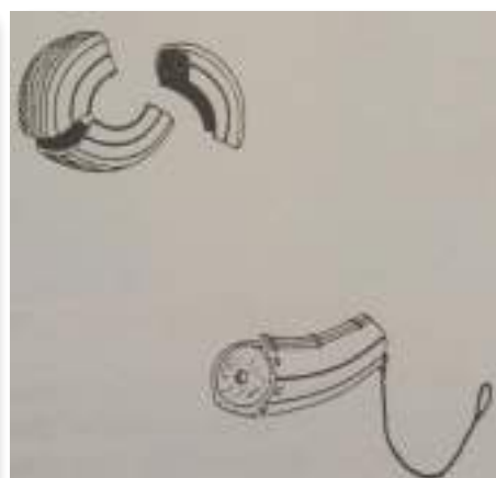
Alcatruz feito a partir de um pneu
